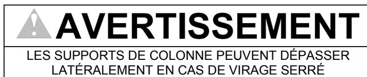
**AVERTISSEMENT : VIRAGE SERRÉ - Des dommages peuvent être causés aux murs, etc. en cas de virage serré étant donné que les supports de colonne dépassent latéralement.**
